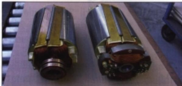
Слева старая, щеточная технология, справа новая, безщеточная технология ENDRESS. Где у левого ротора находятся контактные кольца, у генератора ENDRESS виден интеллигентный возбудитель индуктивно предоставляющий дополнительную мощность при запуске и в критических ситуациях.
