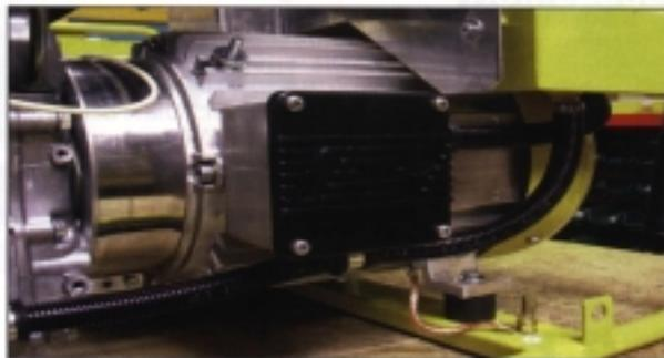
Новый дуплексный генератор ENDRESS в миниэлектростанции. Внешне, своими мощными ребрами охлаждения он напоминает асинхронный генератор, благодаря закрытому устройству он соответствует классу защиты IP 54 и может задействоваться в грязных, под брызгами воды.
