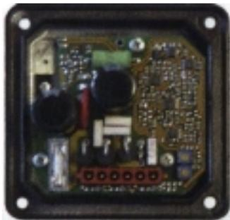
Центр управления, «мозг» нового дуплексного генератора ENDRESS. Электроника регистрирует мощностные характеристики и мотора и потребителя и оптимизирует их взаимодействие.
