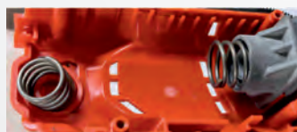
Демпферные пружины для гашения вибрации
