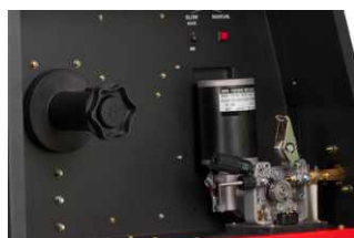
Дополнительные настройки механизма подачи проволоки: наладочная подача проволоки и режим замедленной подачи для прецизионной сварки
