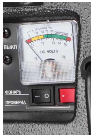
Аналоговый индикатор для контроля за состоянием аккумулятора
