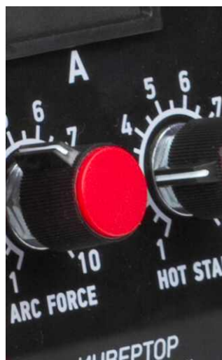
Регулируемые функции ArcForce и HotStart позволяют добиться идеального качества сварки
