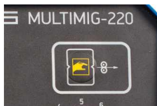
Кнопка для быстрой протяжки проволоки
