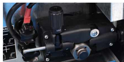
Возможность смены полярности для работы с самозащитной проволокой
