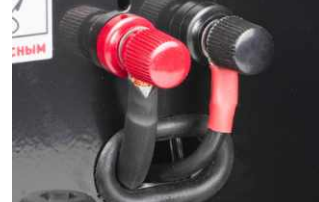
Смена полярности для работы с самозащитной проволокой FLUX
