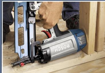
**Ударопрочная металлическая крышка:** защищает блок привода и в случае необходимости позволяет подгонять заготовку
