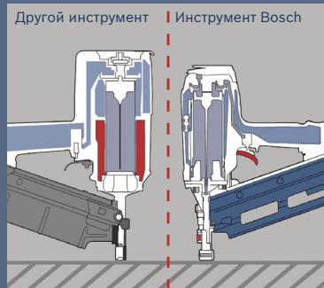
Технология **Full Force Technology** делает пневматический гвоздезабиватель Bosch более компактным по сравнению с другими гвоздезабивателями этого класса.
