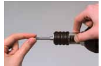
3. Przytrzymaj część zabezpieczającą i wykręć trzpień/tuleję
