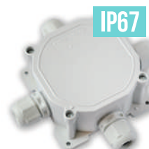
KM-257 (4 ввода) Коробка для разводки проводов IP67 и УХЛ2 Размер коробки: D 75,7 h 44,5 мм Габаритный размер: D 130 h 44,5 мм
