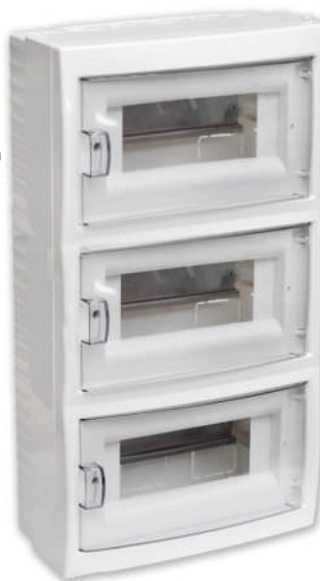
КНС-24ДБ (скрытая установка) Бокс для 24-х автоматических выключателей, 351,7x302x107 мм
