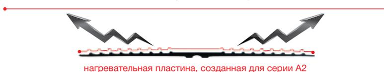
Благодаря специальной «зубчатой» форме увеличивается общая поверхность теплоотдачи прибора и, как следствие, возрастает и скорость обогрева.
