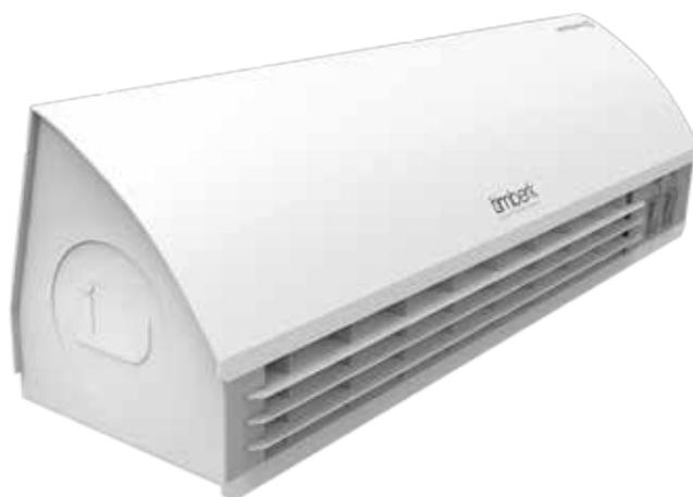
Тепловые завесы Timberk создают равномерный высокоскоростной поток по всей площади рабочего проёма. В качестве нагревателей используется высокоэффективные СТИЧ-элементы. Стальной корпус завес покрыт высококачественным полимерным покрытием. Для обеспечения безопасной работы, завеса снабжена термopредохранителем отключающим СТИЧ-элементы в случае перегрева. Управление завесами мощностью 3 и 5 кВт осуществляется с помощью клавишных переключателей блока управления.
