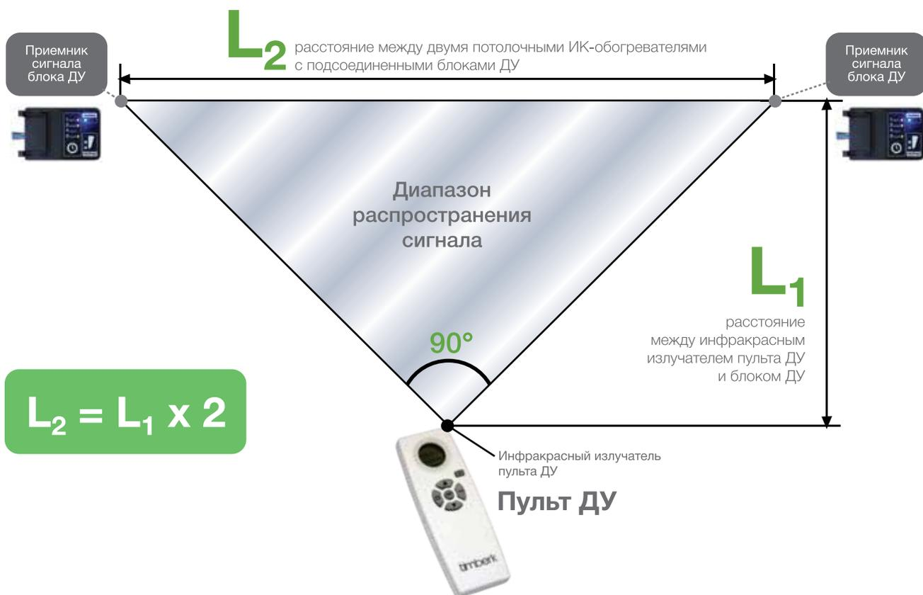
Блок дистанционного управления инфракрасными потолочными обогревателями Timberk позволяет совершенно иначе взглянуть на эксплуатационные характеристики привычных приборов.
