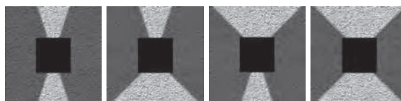
Варианты настроек угла светораспределения PwL-120120/0-90D
