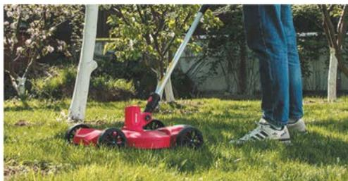
Данная модель поставляется с тележкой, с помощью которой можно легко преобразовать триммер в газонокосилку без использования дополнительных инструментов! Высоту реза можно регулировать от 35 до 55 мм путём переставления колёс на нужный уровень.
