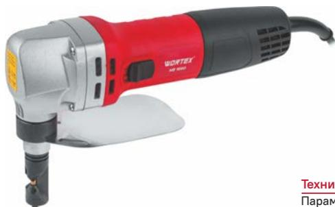
Ножницы высечные – это мощный инструмент для выполнения криволинейных вырезов в листовом металле. Ножницы имеют высококачественные металлические узлы редуктора и оснащены тонкой эргономичной рукояткой. Так же они имеют большую толщину реза стали до 1,8 мм и цветных металлов до 2,5 мм.
