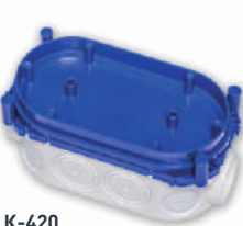
K-420 Коробка для установки электроустановочных изделий Размер коробки: 153,5x82,5x71,5 мм
