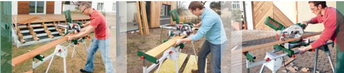
Благодаря своим регулируемым боковинам с роликами и боковым упорам стационарный стол РТА 2400 – отличное решение для обработки крупногабаритных заготовок.
