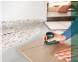
Выполнение точных прямых или угловых разрезов: просто зажмите плитку в установке для распиловки PLS 300, выровняйте и разрежьте её с помощью РТС 1. Или ведите РТС 1 вдоль произвольно отмеченной линии.
