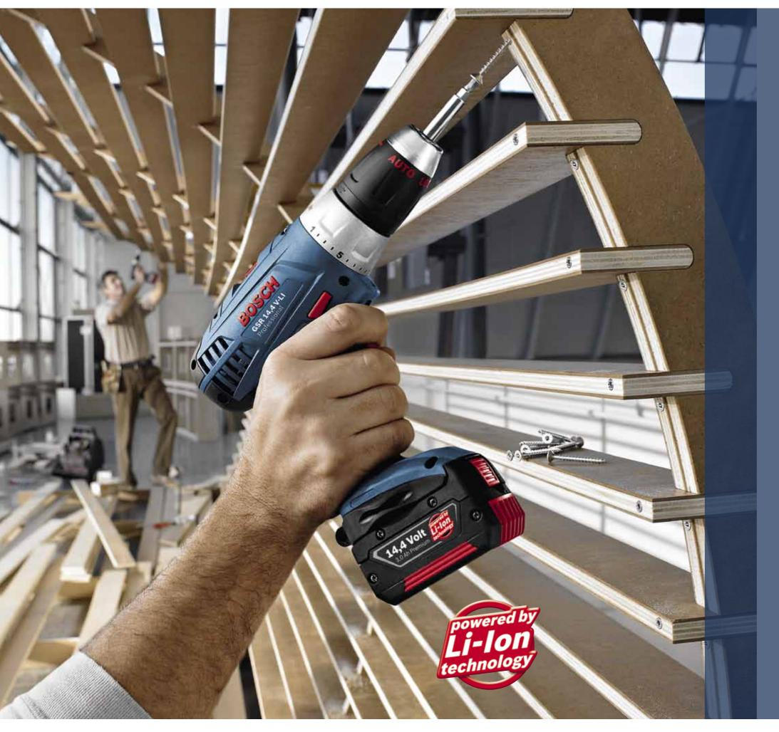
«Раньше мы должны были постоянно подзаряжать наполовину разряженные аккумуляторы для сохранения мощности инструментов. С новыми шуруповёртами с литий-ионными аккумуляторами это теперь в прошлом. Всего на одном заряде мы можем завернуть более чем 200 шурупов 6х60 мм.»
